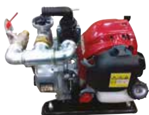
8m 3 Ref. 863 Pompe 8 m 3 /h (133 l/mn) pression 3,6 bars moteur Honda Régulation By pass
