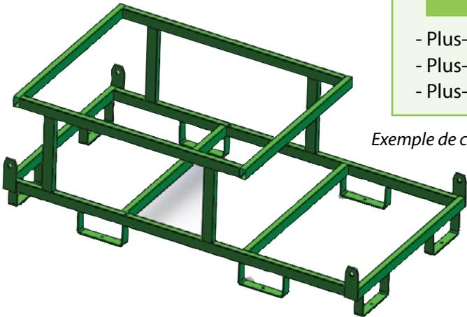
Exemple de châssis avec passage de fourche
